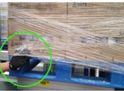
**3** Colocar el Plástico colgante, deberá colocarse por dentro, para evitar que se atore en las grúas.
