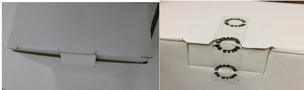
Imagen 5. Colocación cinta de calidad.
